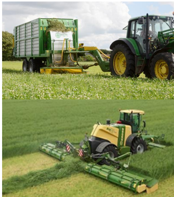
Figur 4: MaksiGrasser (FOTO: Landbrugsavisen) og Skårlægger, der samler græsset i en streng (FOTO: Krone)
